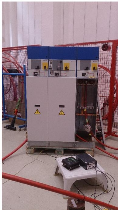
*Figura 6.3: Equipos de diagnóstico de aislamiento eléctrico y detección de defectos a tierra*
